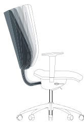
Inclinaison du dossier 2 à 5 positions Backrest inclination adjustment (2 to 5 positions) Kantelbare rug 2 tot 5 posities
